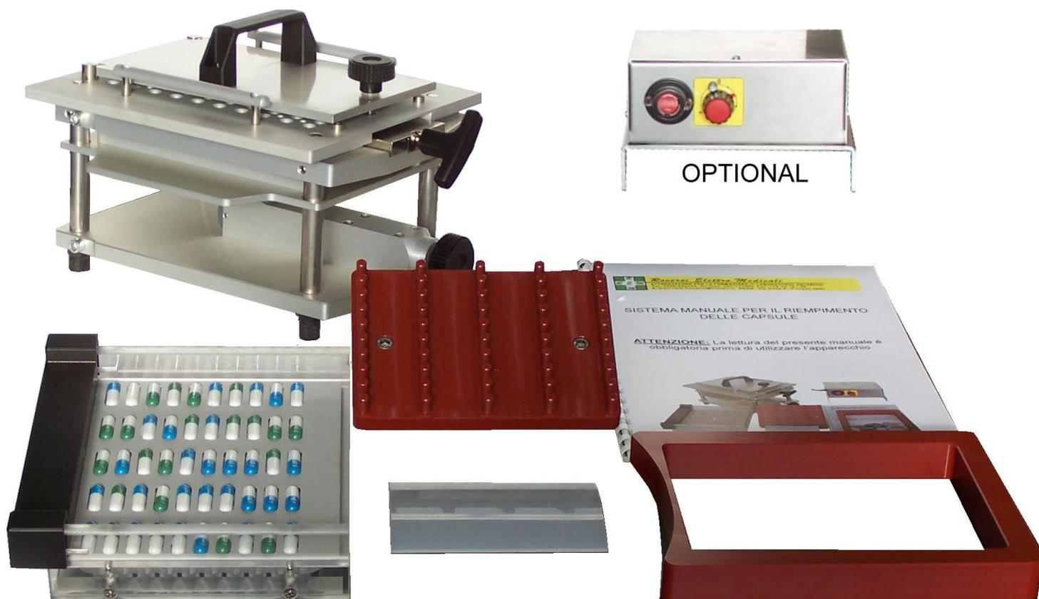
Opercolatrice dalle dimensioni molto contenute e dalla forma compatta, come un foglio A4, interamente costruita in alluminio anodizzato. Disponibile in due formati, da 100 e da 300, la versione da 300 ha in dotazione anche una piastra per poter lavorare anche solo 100 capsule per volta. Per il cambio formato bastano 15 secondi e non è richiesto alcun utensile essendo la regolazione del piano d'appoggio regolato da un congegno meccanico estremamente preciso.
