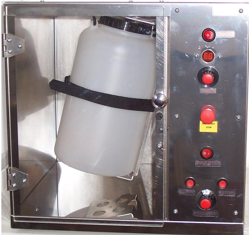
L'apparecchiatura è costituita da un supporto ruotante sul quale viene fissato, con cinghiette con chiusura velcro, il contenitore in plastica per alimenti nel quale inserire i prodotti da miscelare. Tramite un'inclinazione rispetto l'asse di rotazione, la miscelazione viene effettuata seguendo un figura ad 8 con rotolamento sia longitudinale che assiale. Inoltre, con l'inversione automatica del senso di rotazione, è possibile evitare l'effetto di scivolamento tipico di molte polveri.
